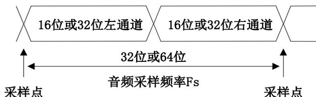
**图 21-10 音频采样频率定义**
