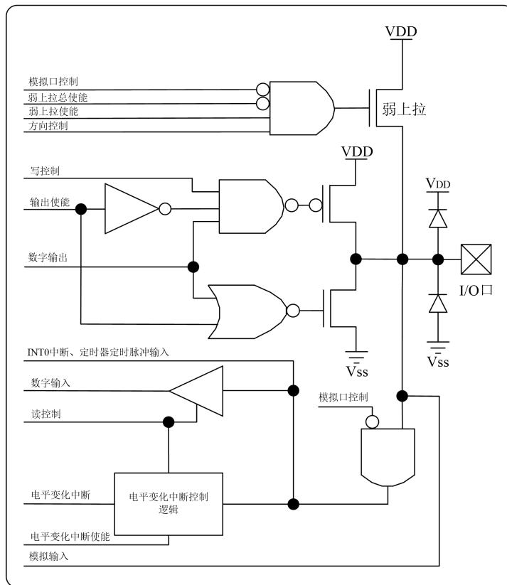
图 2.3.1 P0.1、P0.2、P0.7 口引脚原理框图
