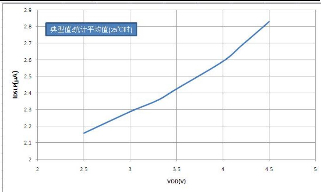
图 16.4 不同 VDD 时典型 IDSLP – VDD 关系曲线图(深度休眠模式, 禁止所有外设)
