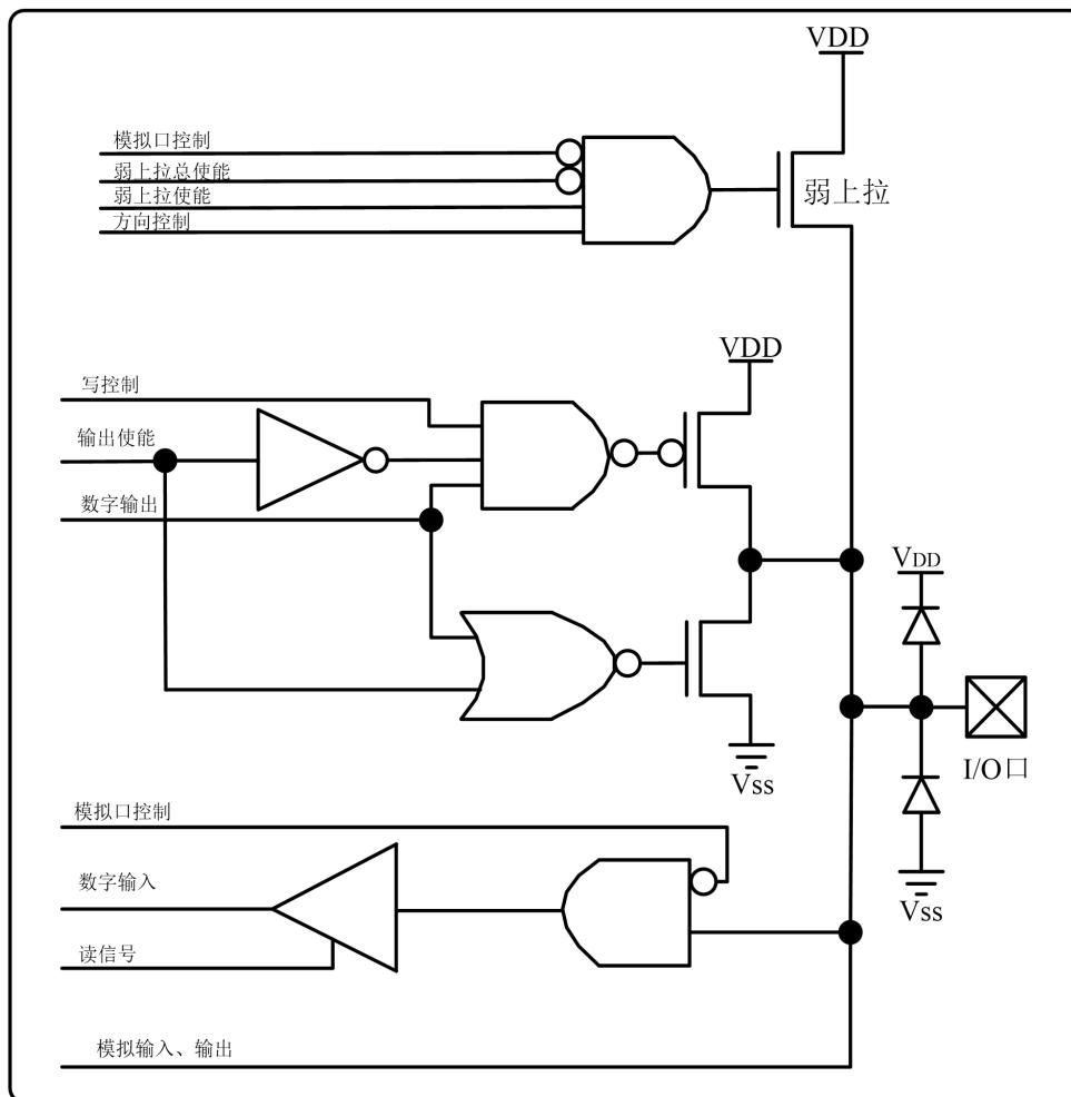
图 2.9 P6 口引脚原理功能框图
