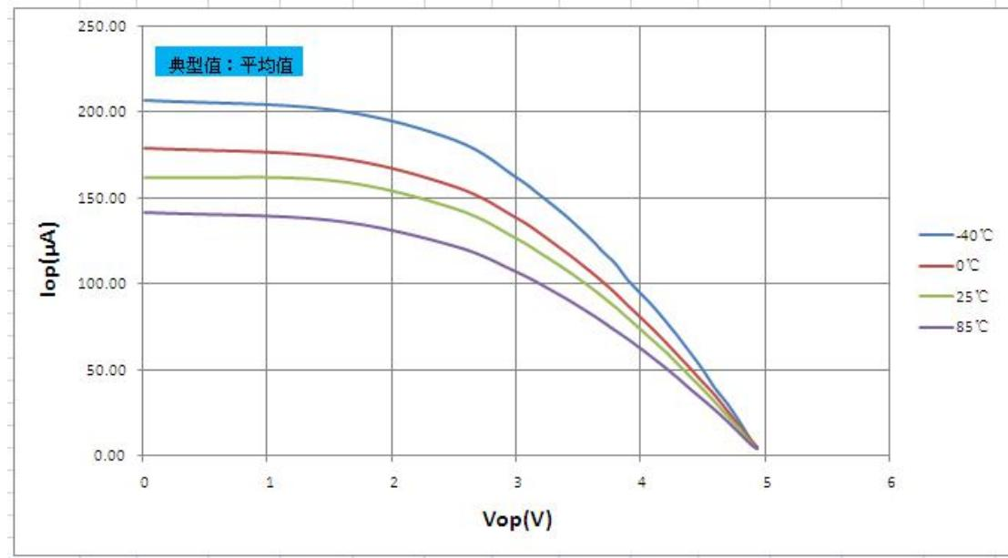
图 16.20 上拉功能打开时端口电压  $V_{OP}$  – 电流  $I_{OP}$  关系曲线图 ( $V_{DD} = 5.0V$ )
