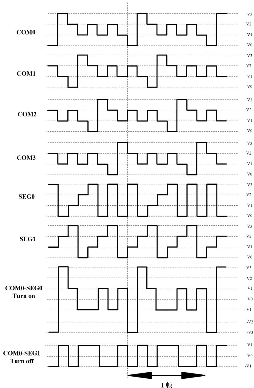
图 8.13 在 1/4 复用、1/3 偏置驱动时的 A 型波形
