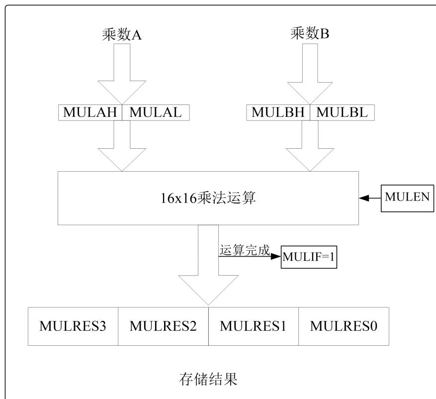
图 11.1  $16 \times 16$  硬件乘法器原理框图
