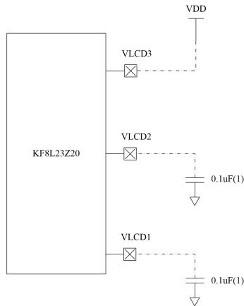
图 8.4 LCD 使用内部分压电阻串时外围推荐线路
