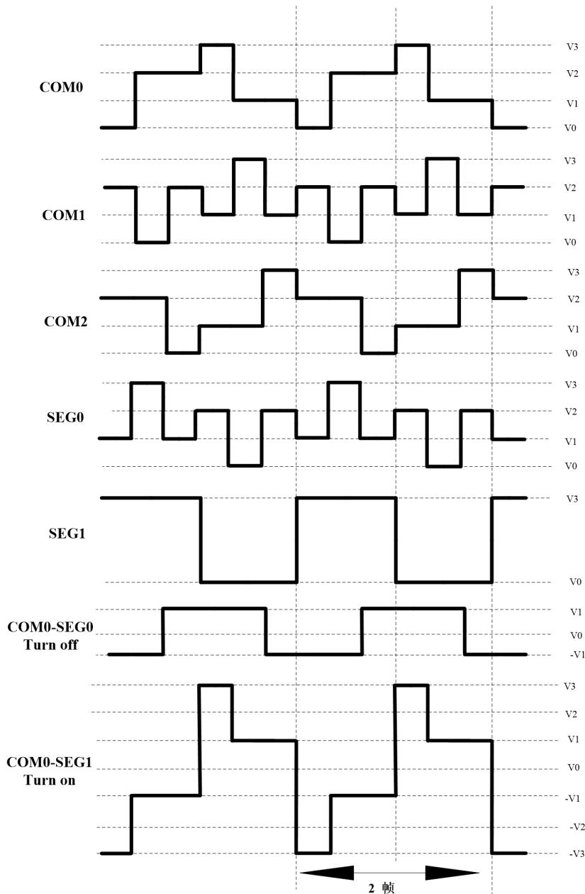
图 8.12 在 1/3 复用、1/3 偏置驱动时的 B 型波形
