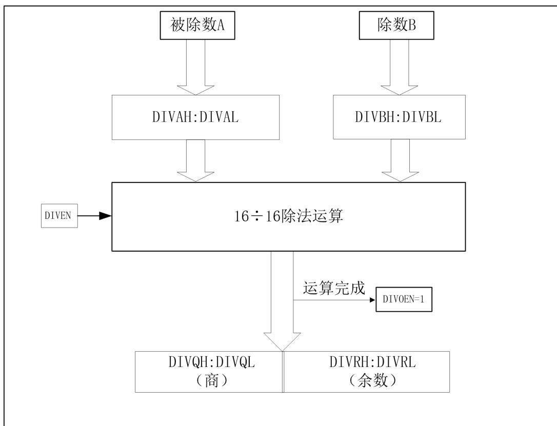
图 12.1 硬件除法器原理框图
