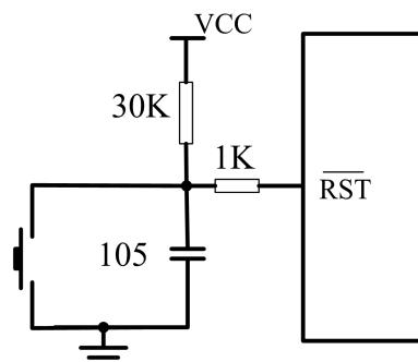
图 13.2 建议 RST 复位电路
