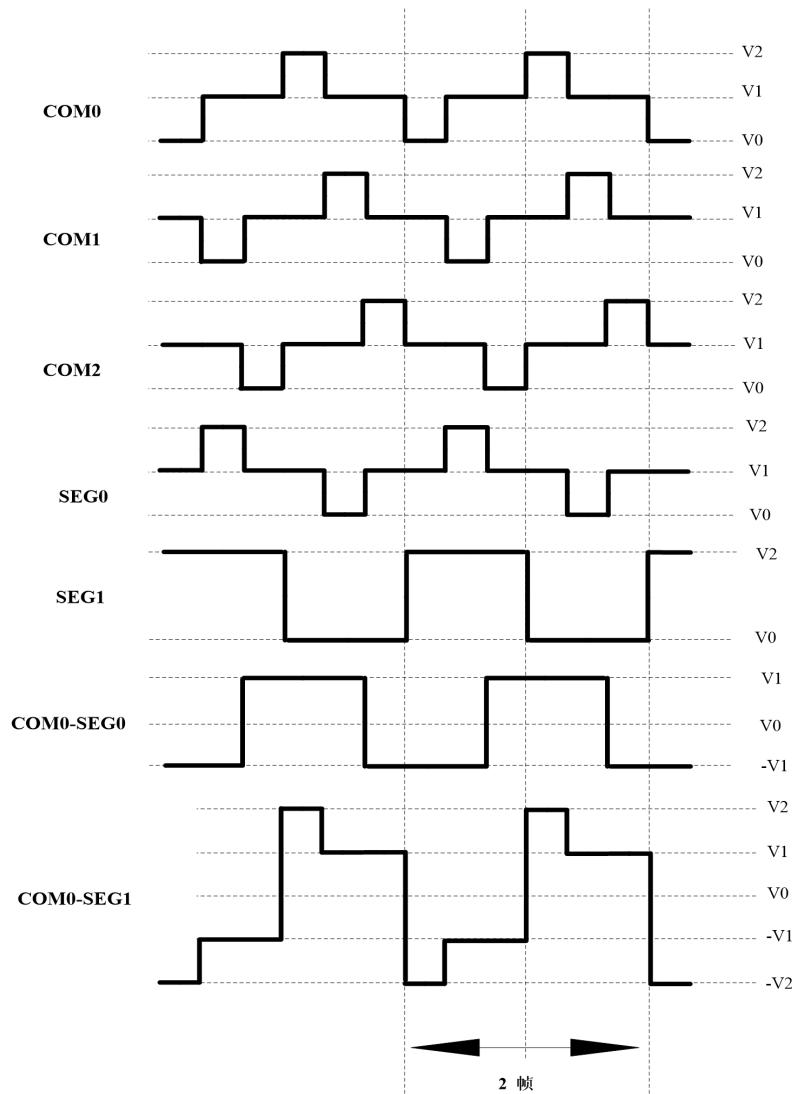
图 8.10 在 1/3 复用、1/2 偏置驱动时的 B 型波形
