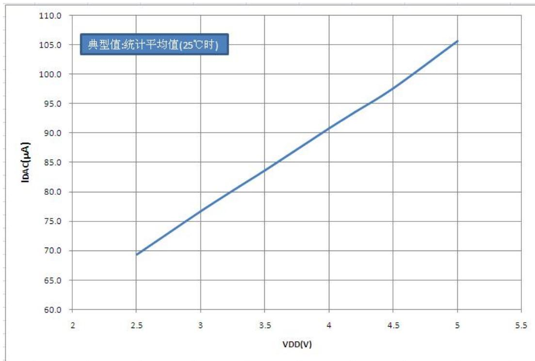
图 16.14 欠压复位电流  $IDAC$  –  $VDD$  关系曲线图
