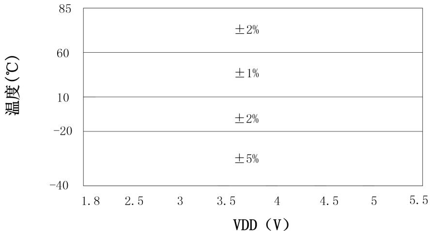
图 16.1 INTHF 频率精度与 VDD 和温度关系图
