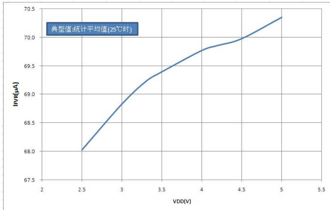
图 16.15 欠压复位电流  $IFVR$  –  $VDD$  关系曲线图
