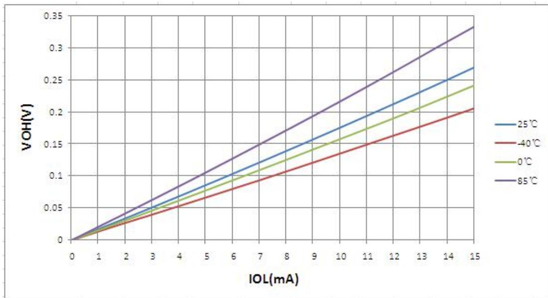
图 16.19 不同温度时  $V_{OH} - I_{OL}$  关系曲线图 ( $V_{DD} = 3.0V$ )
