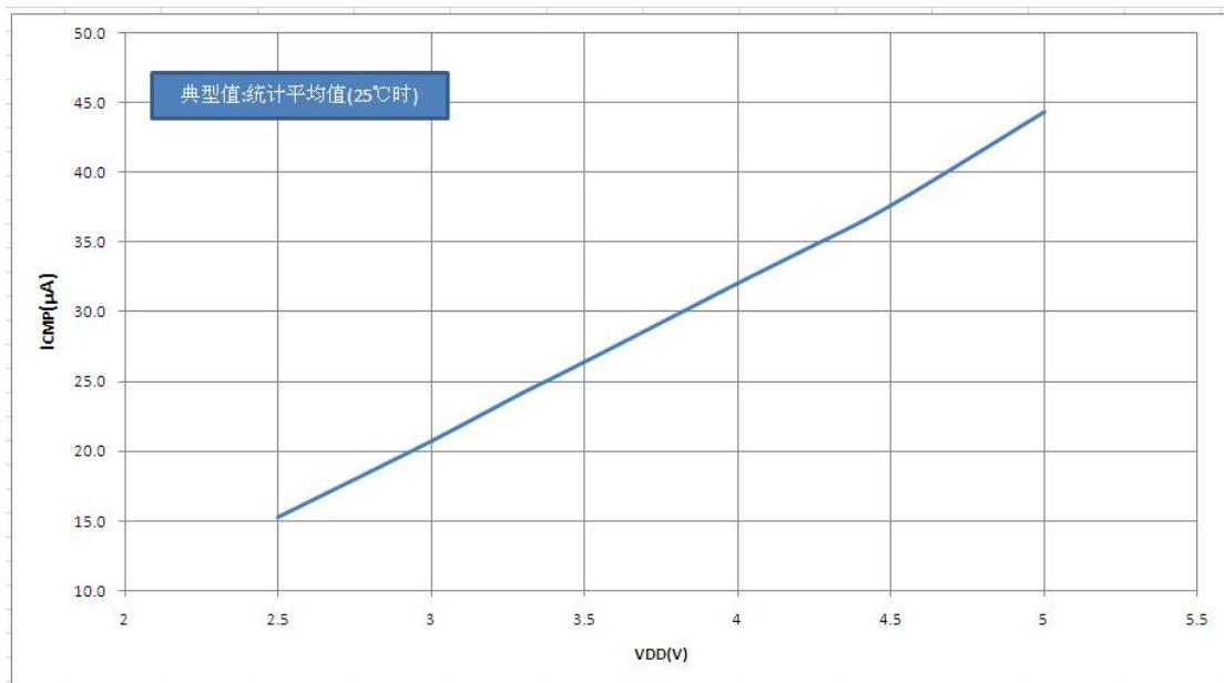
图 16.9 比较器电流  $I_{CMP}$  —  $V_{DD}$  关系曲线图 (使能一路比较器)
