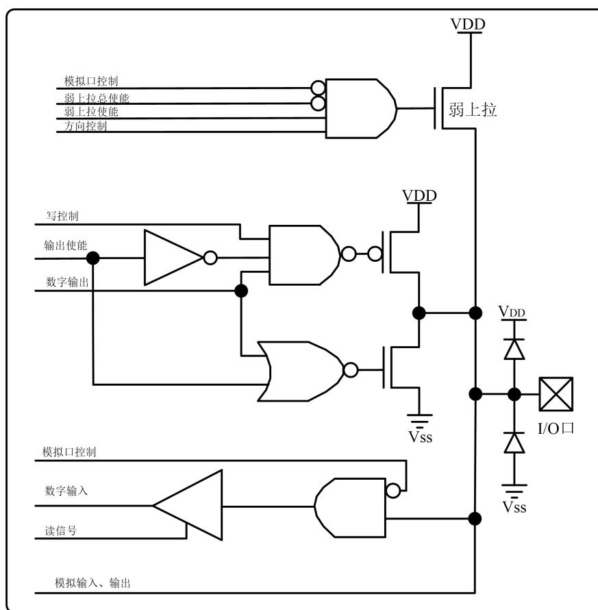
图 2.8 P5 口引脚原理功能框图
