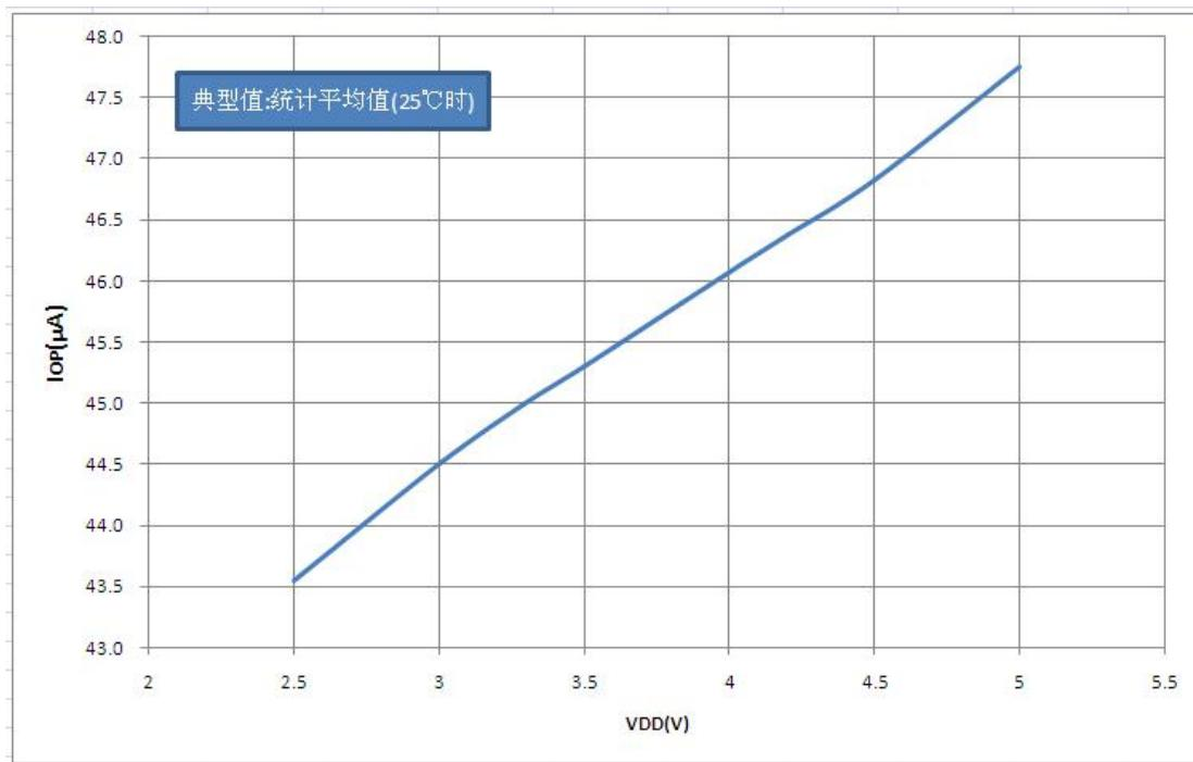
图 16.10 运算放大器电流  $I_{OP}$  –  $V_{DD}$  关系曲线图 (使能一路比较器)
