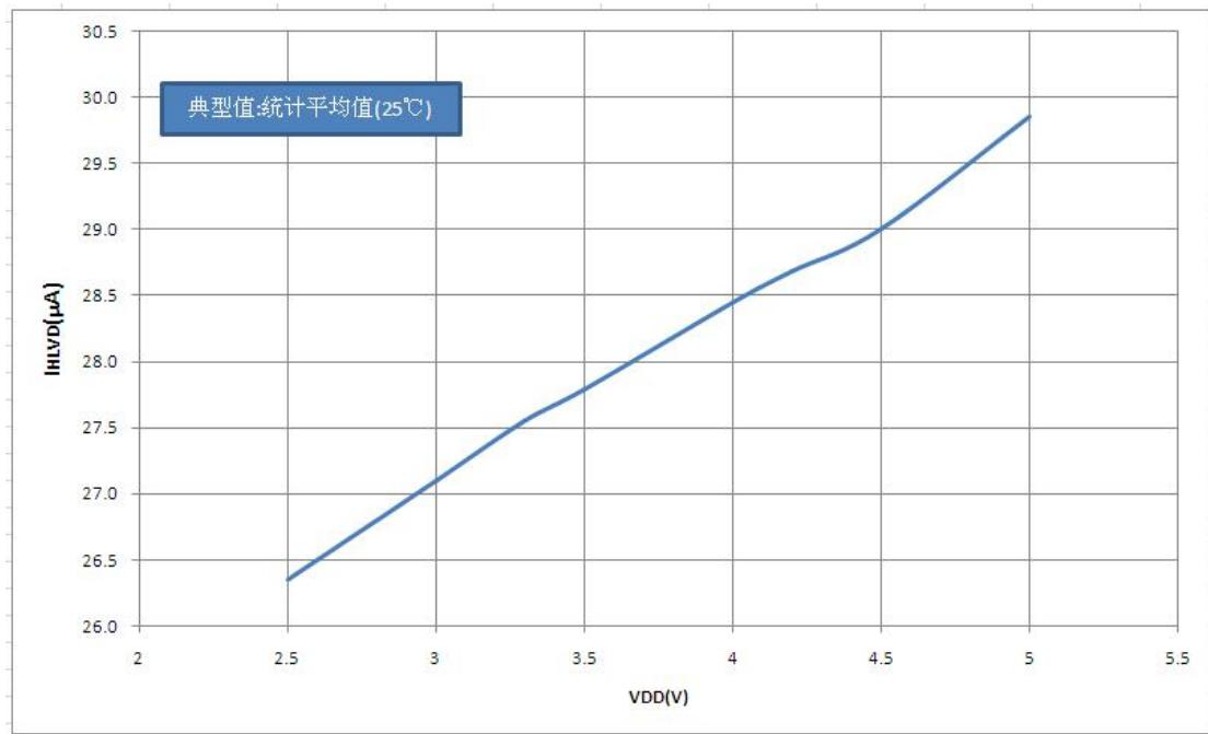
图 16.12 欠压复位电流  $I_{HLVD}$  —  $V_{DD}$  关系曲线图
