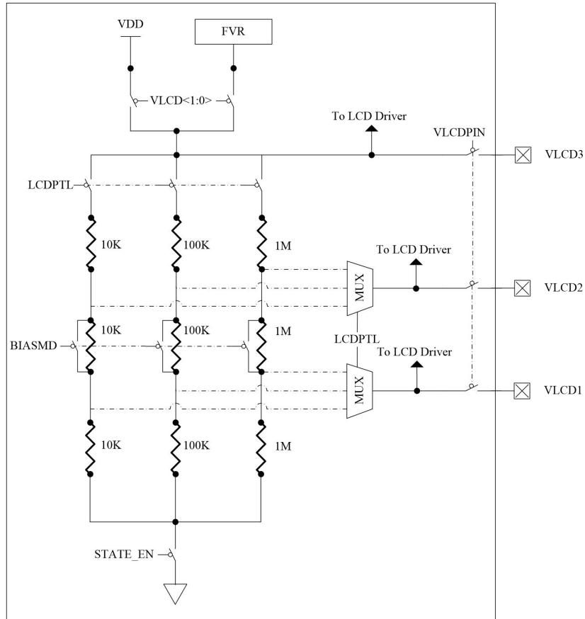
图 8.3 LCD 偏置电路原理框图
