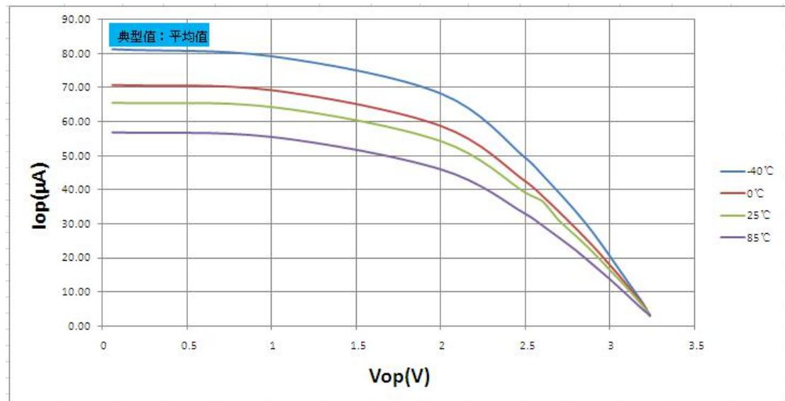
图 16.21 上拉功能打开时端口电压  $V_{OP}$  – 电流  $I_{OP}$  关系曲线图 ( $V_{DD} = 3.3V$ )
