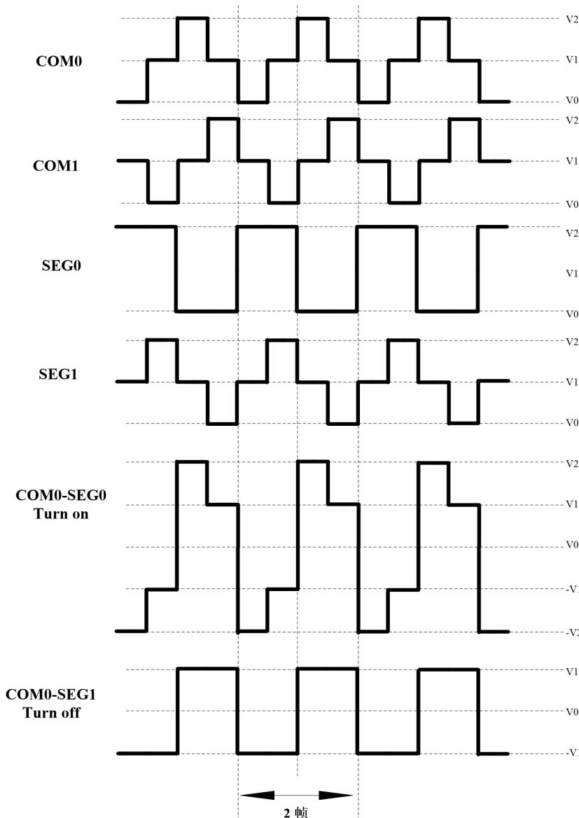
图 8.6 在 1/2 复用、1/2 偏置驱动时的 B 型波形
