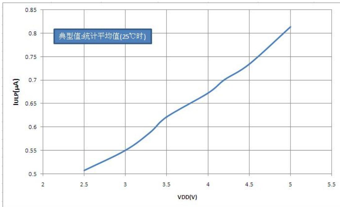
图 16.5 不同VDD 时典型IULP – VDD 关系曲线图(超低功耗模式, 禁止所有外设)
