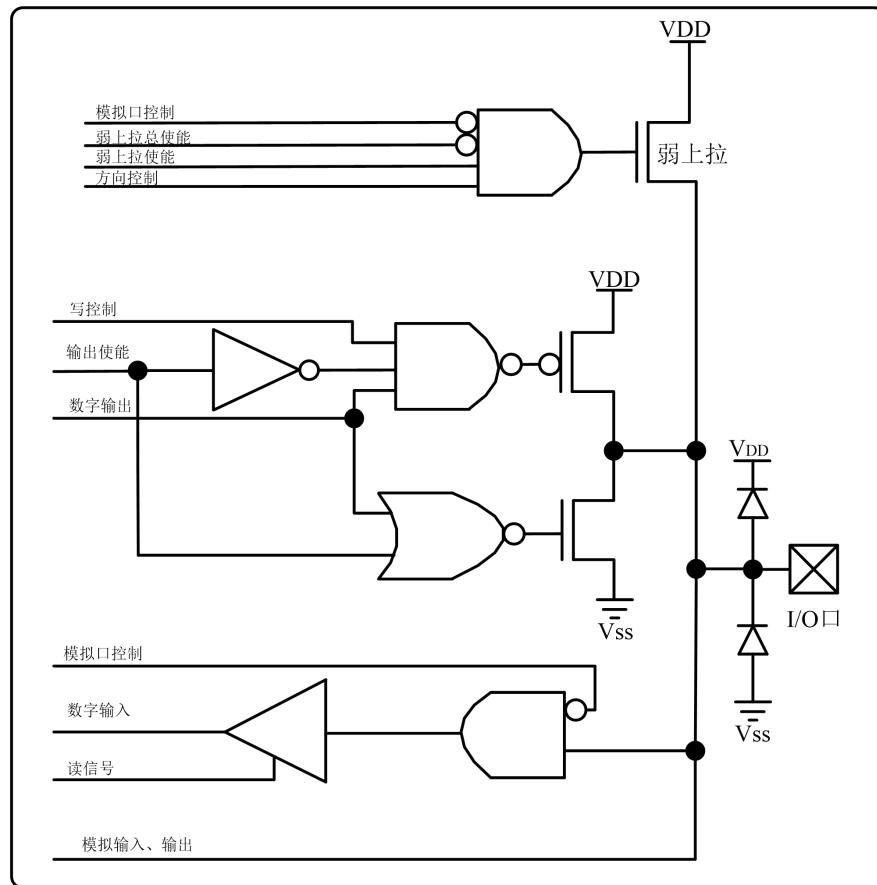
图 2.7 P4 口引脚原理功能框图
