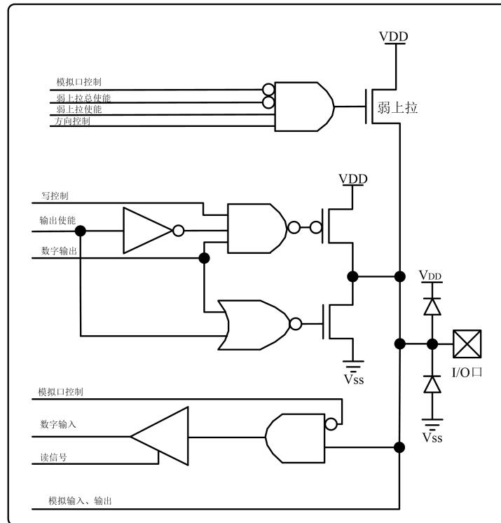
图 2.4 P1 口引脚原理功能框图
