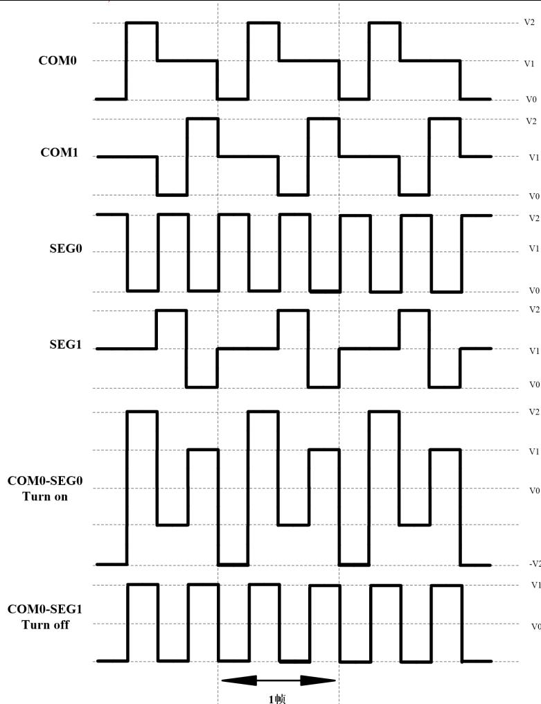
图 8.5 在 1/2 复用、1/2 偏置驱动时的 A 型波形
