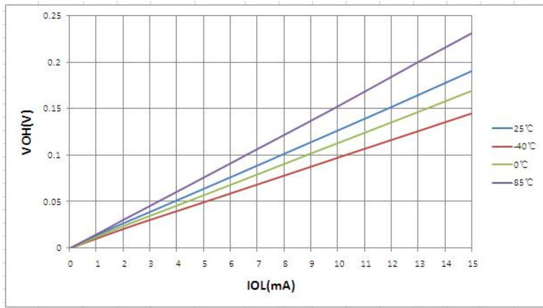
图 16.18 不同温度时  $V_{OH} - I_{OL}$  关系曲线图 ( $V_{DD} = 5.0V$ )
