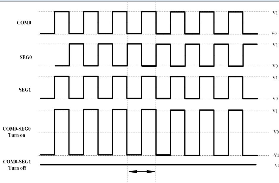
图 8.4 在静态驱动时 A/B 型波形
