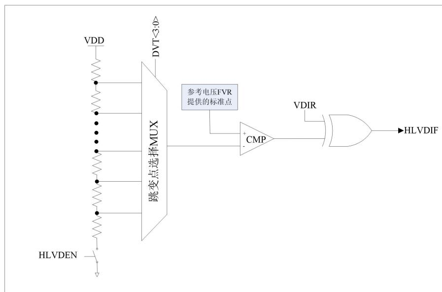
图 10.1 高低压检测原理图
