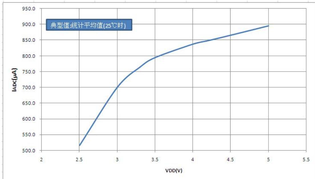
图 16.13 欠压复位电流  $I_{ADC}$  —  $V_{DD}$  关系曲线图
