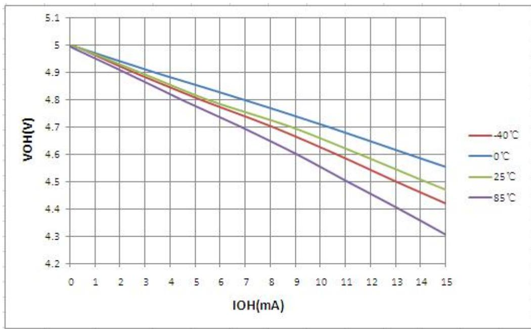
图 16.16 不同温度时  $V_{OH}$  –  $I_{OH}$  关系曲线图 ( $V_{DD} = 5.0V$ )
