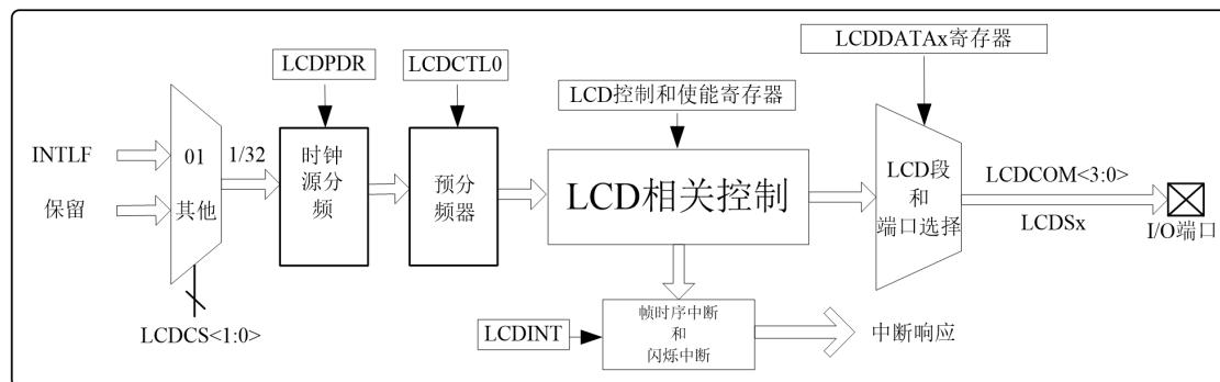
图 8.1 LCD 显示框图
