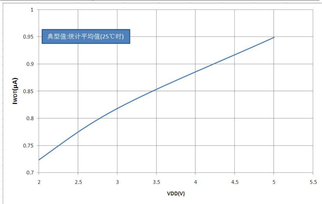
图 16.8 看门狗电流  $I_{WDT}$  —  $V_{DD}$  关系曲线图
