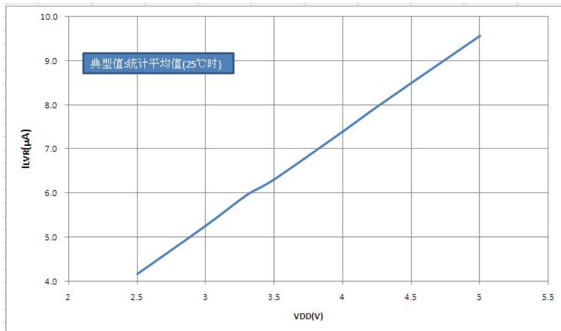
图 16.11 欠压复位电流  $I_{LVR}$  –  $V_{DD}$  关系曲线图
