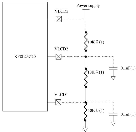
图 8.5 LCD 使用外部分压电阻串时外围推荐线路
