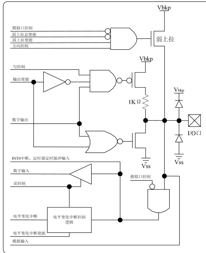
图 2.3.2 P0.3 口引脚原理框图
