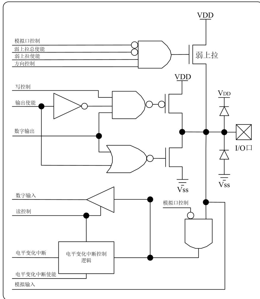
图 2.6 P3 口引脚原理功能框图
