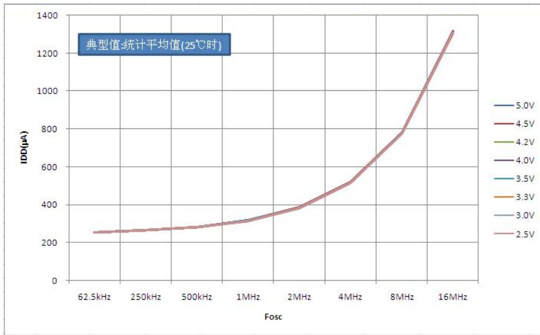
图 16.2 不同 VDD 时典型 IDD — Fosc 关系曲线图(HFINTOSC 模式)
