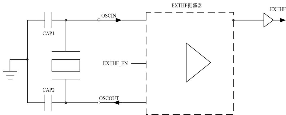
图 1.3 外部高频振荡器原理图
