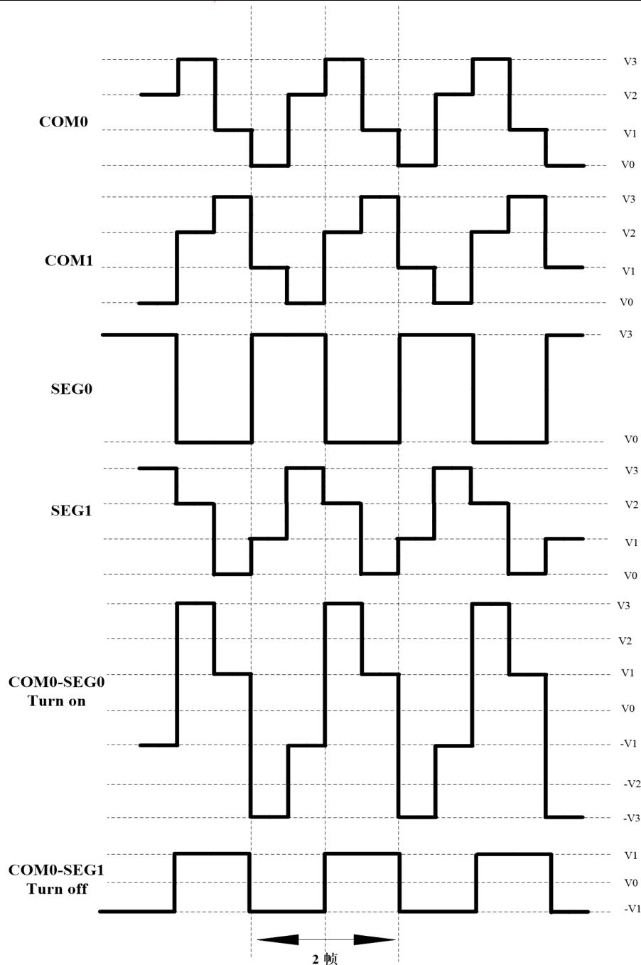
图 8.8 在 1/2 复用、1/3 偏置驱动时的 B 型波形
