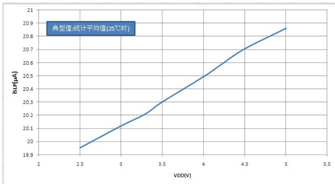
图 16.3 不同 VDD 时典型 ISLP — VDD 关系曲线图(普通休眠模式, 禁止所有外设)
