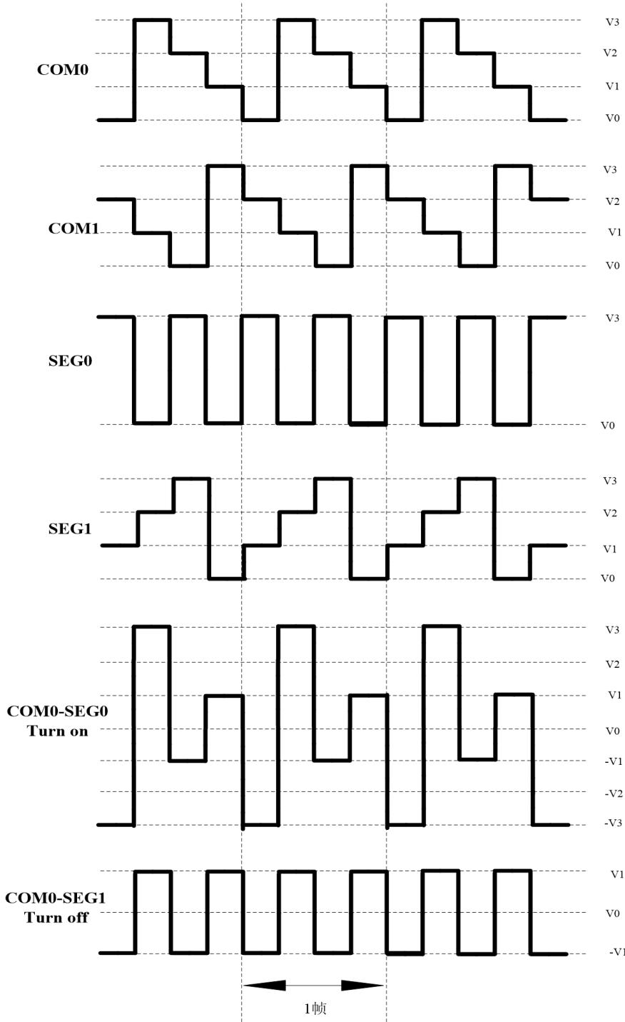
图 8.7 在 1/2 复用，1/3 偏置驱动时的 A 型波形
