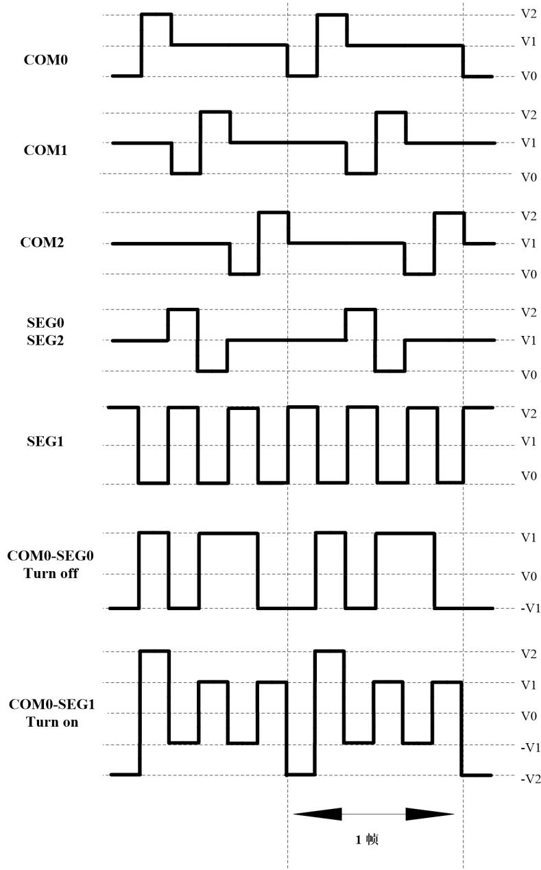
图 8.9 在 1/3 复用，1/2 偏置驱动时的 A 型波形
