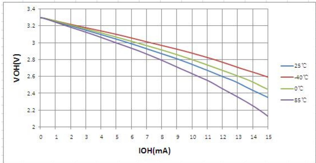
图 16.17 不同温度时  $V_{OH}$  –  $I_{OH}$  关系曲线图 ( $V_{DD} = 3.0V$ )
