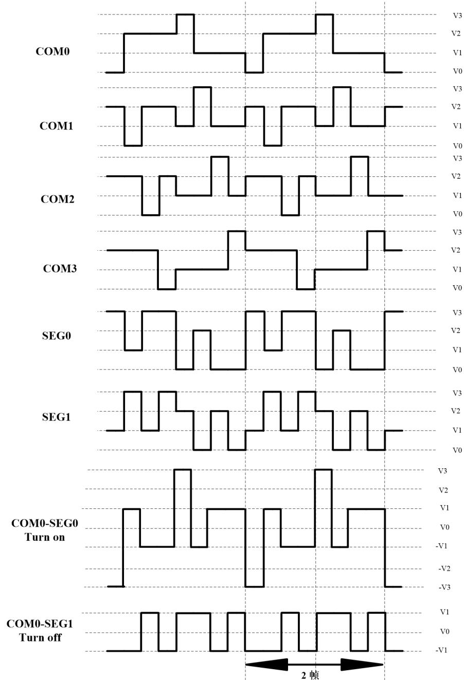
图 8.14 在 1/4 复用、1/3 偏置驱动时的 B 型波形
