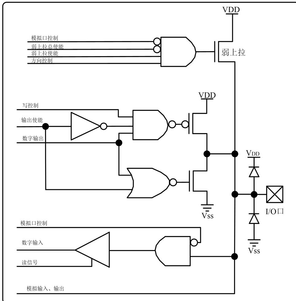
图 2.10 P7 口引脚原理功能框图
