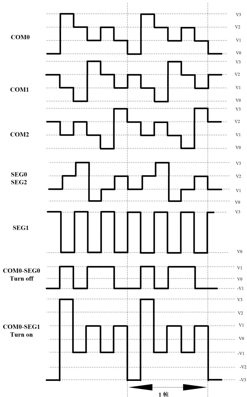
图 8.11 在 1/3 复用、1/3 偏置驱动时的 A 型波形
