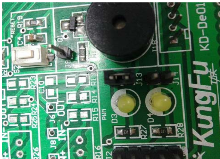
图1. 2: 跳线帽接线图
