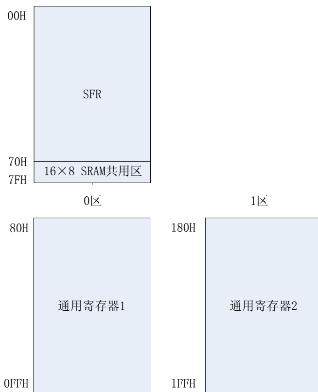
图 3.4 数据存储器地址映射图
