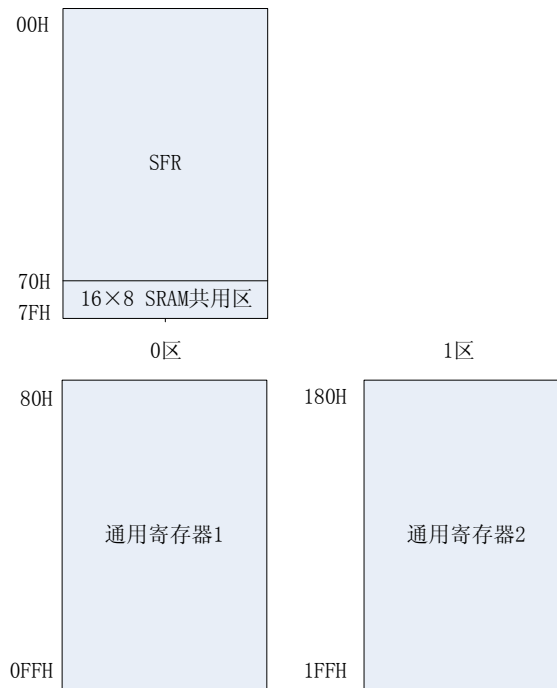
图 3.4 数据存储器地址映射图
