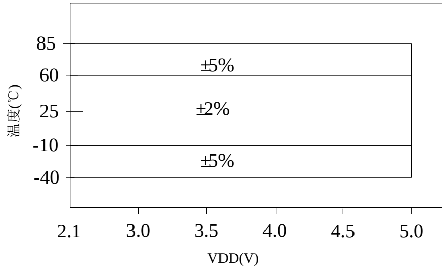
图 14.1 INTHF 振荡器频率精度与温度、电压之间的关系
